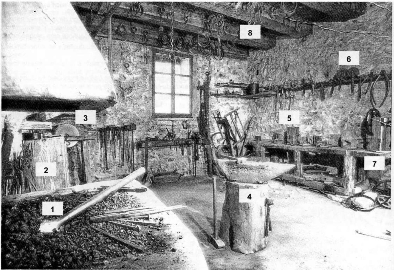
Voici une vue d'un atelier de charron forgeron : 1 – Foyer de forge. 2 – Pinces et outils de préempti 3 – Meule. 4 – Enclume et marteaux. 5 – Moyeux de roue en préparation. 6 – Roulettes de mesure de circonférence et compas 7 – roue crantée en fabrication 8 – Anneaux de cerclage préparés.
